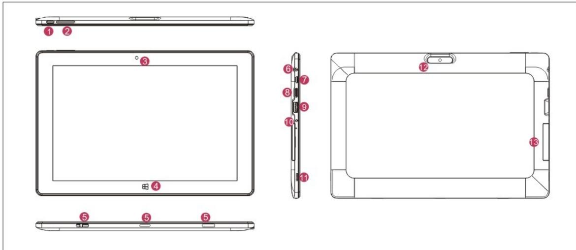
○1 Bouton Marche/Arrêt : Appuyez sur ce bouton pour démarrer ou pour fermer le panneau de l'écran tactile. Vous pouvez également utiliser ce bouton pour mettre l'appareil en mode de veille ou pour le réactiver.
